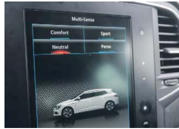
Vier Modi ändern die Reaktion von Motor und Lenkung, aber nicht die Fahrwerksabstimmung.
